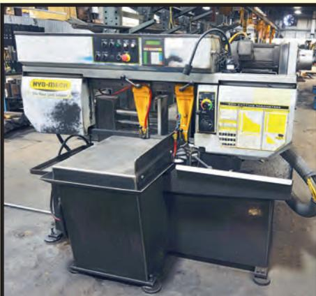
**HYD-MECH S-20A AUTOMATIC HORIZONTAL BANDSAW**
